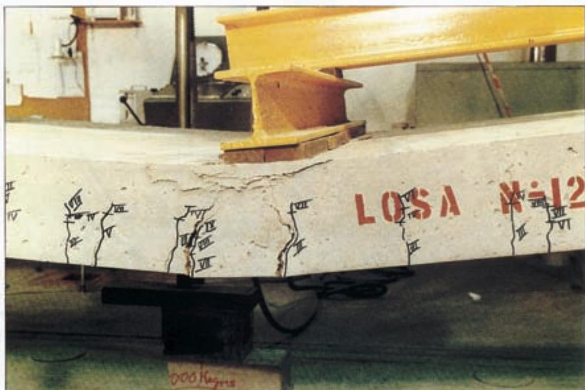
Foto 4. Detalle rotura plástica formada en losa 12 (armada con acero de alta ductilidad).
