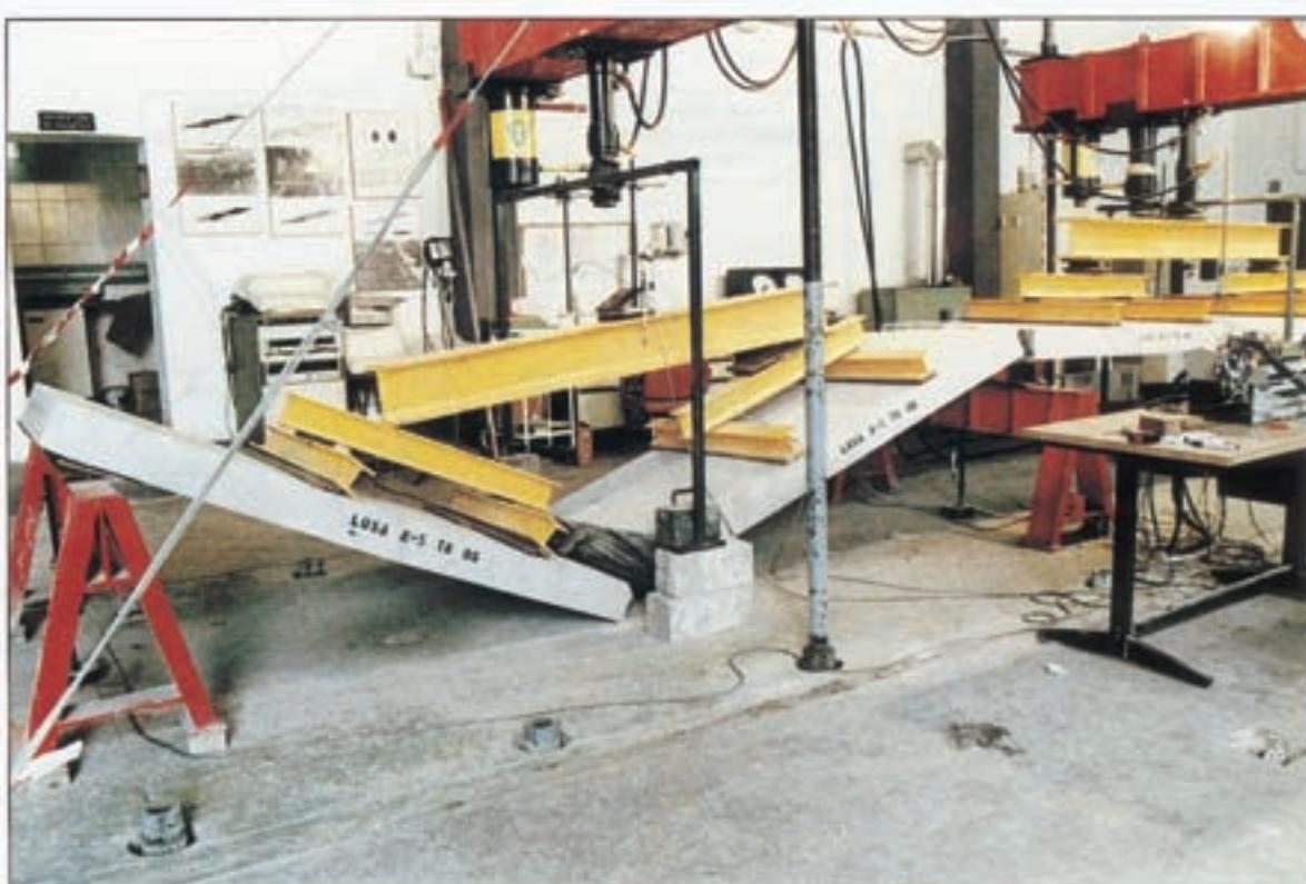
Foto 3. Colapso losa 5 (armada con acero de baja ductilidad).
